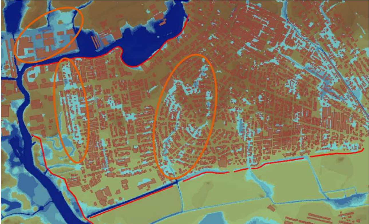
Figura 3 Zonas con protección inadecuada, periodo de retorno 100 años.
